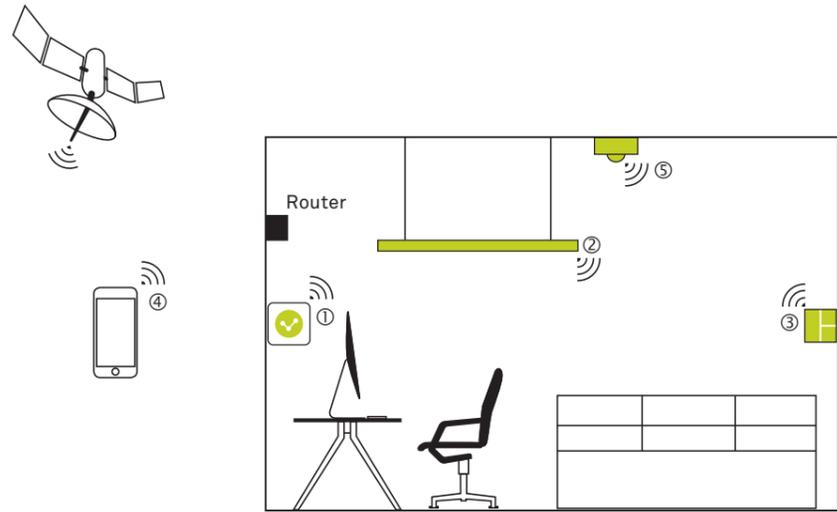
Zentraler Systemknoten des RibagAir Smart Lighting Systems ist das ① **RibagAir-Gateway**, das sämtliche ② **RibagAir-Leuchten** und ③ **ZigBee®-Funktaster** untereinander vernetzt und über das Internet mit der Aussenwelt verbindet. Ganz ohne Steuerverdrahtung.
